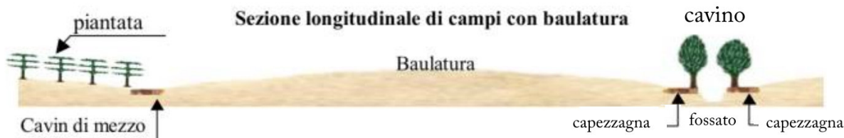
Figura 23. Schema di sistemazione dei campi a baulatura
